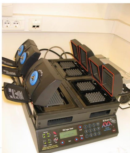
Эволюция ПЦР. Амплификатор “Tetrad Thermal Cycler” (MJ Research PTC-225, USA)
