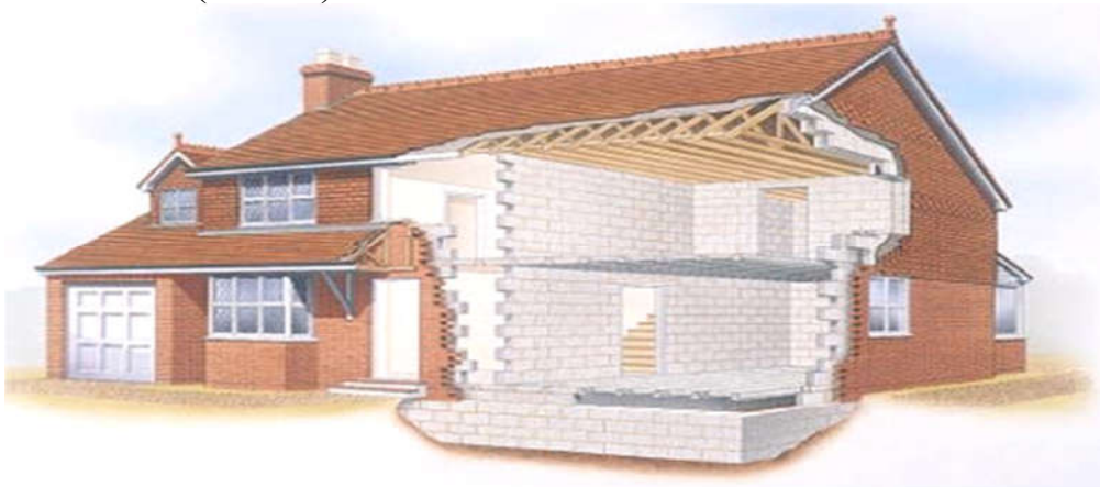
8-rasm. Binoning fasadlari bo'yicha qo'shimcha issiqlik qoplamasi qo'yilgan holat.
