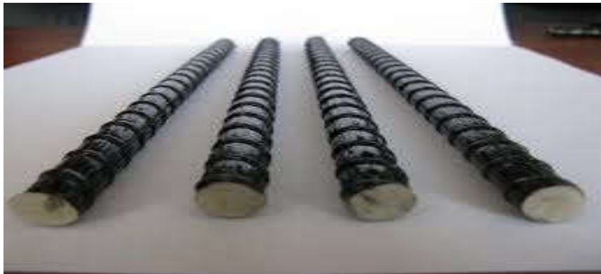
5-rasm. Bazalt-plastikli armatura
