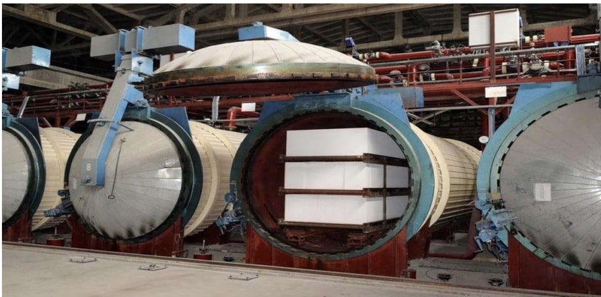
12-rasm. Avtoklavda qotirilgan gaz silikatli blok.
