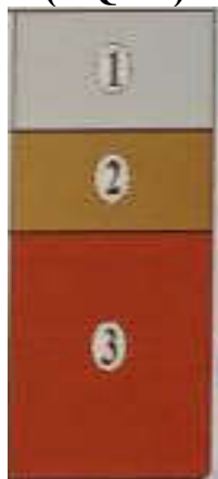
2.11-rasm. 1-sement bilan ishlov berilgan grunt; 2-sanoat chiqindi materialлари bilan grunt qorishmasi; 3-yo'l poyi.
