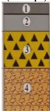
2.12-rasm. 1-mayda donali zich issiq asfaltbeton; 2-yirik donali zich issiq asfaltbeton; 3-sement bilan mustahkamlangan chaqirtosh; 4-qum-shag'al qorishmasi.
