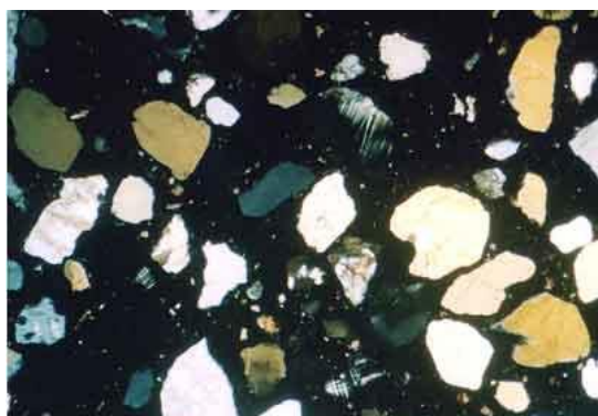
7-Rasm B. Sement plitkasini mikrorasmlari – qora rangdagi asosiy massa – magnezial sement, yirik donali oq rangli zarrachalar – dala shpatlari, slyudalar tarkibida tutgan qum minerallari. kattalashtirish darajasi 25x. O'tqazuvchi nur, nikollar kesishga xolda.
