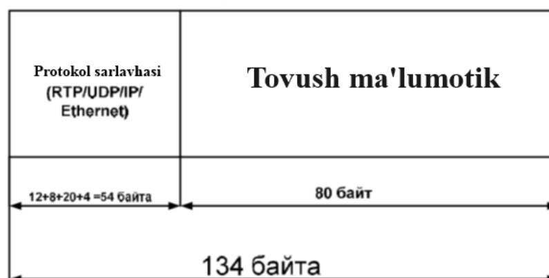
3.12- rasm. IP tarmog'i orqali uzatilayotgan G.711 kadr formati
