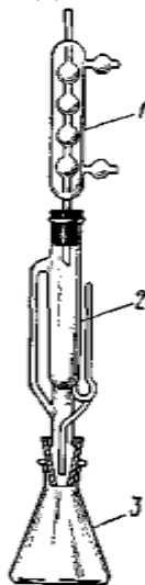
7-расм. Соксет аппарати: 1- совутгич; 2-экстрактор; 3- колба.
