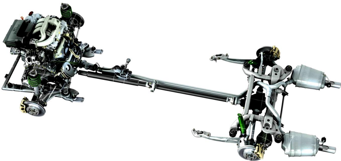
3.2-rasm. Orqa yetakchi avtomobilning transmissiyasi ko‘rinishi
