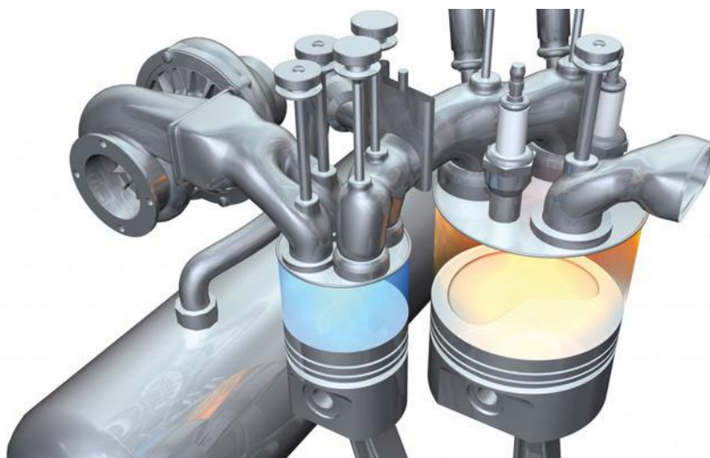
1.13-rasm. Issiqlik ajratilgan dvigatel
