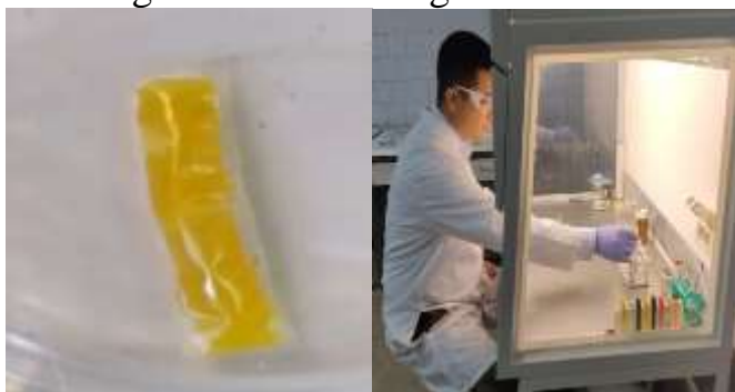
Rasm-9. Brakonlarni sun'iy oziqa muhitlarida ko'paytirish uchun politelin salafanlardan ishlab chiqilayotgan qopcha shaklidagi sun'iy qurt.(Laboratoriya tajribalari, 2016 y)
