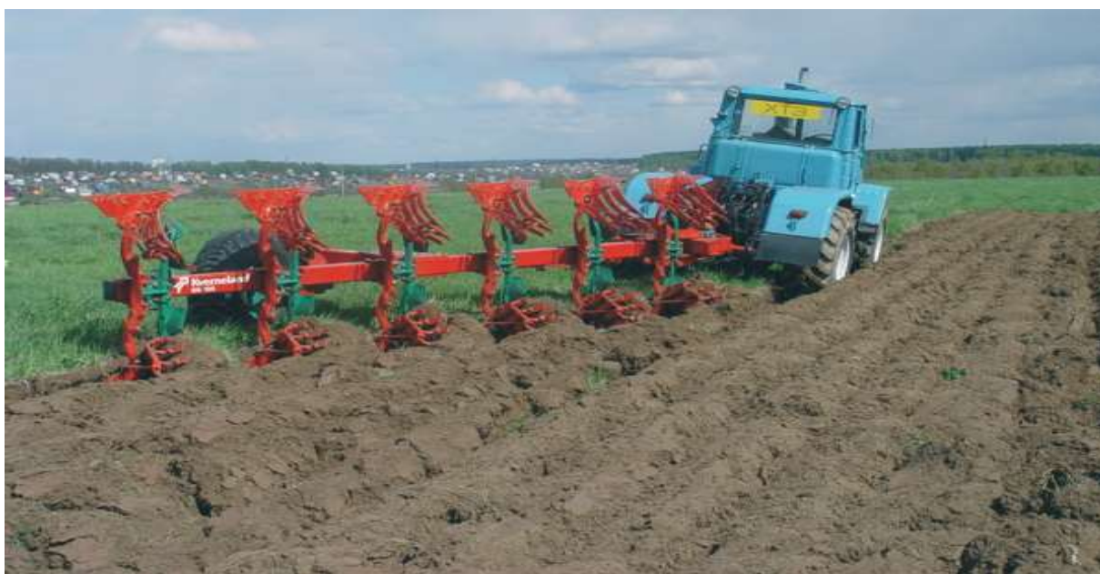
20-rasm. Tokzor barpo qilinadigan yerni 45-50 sm chuqurlikda shudgorlash
