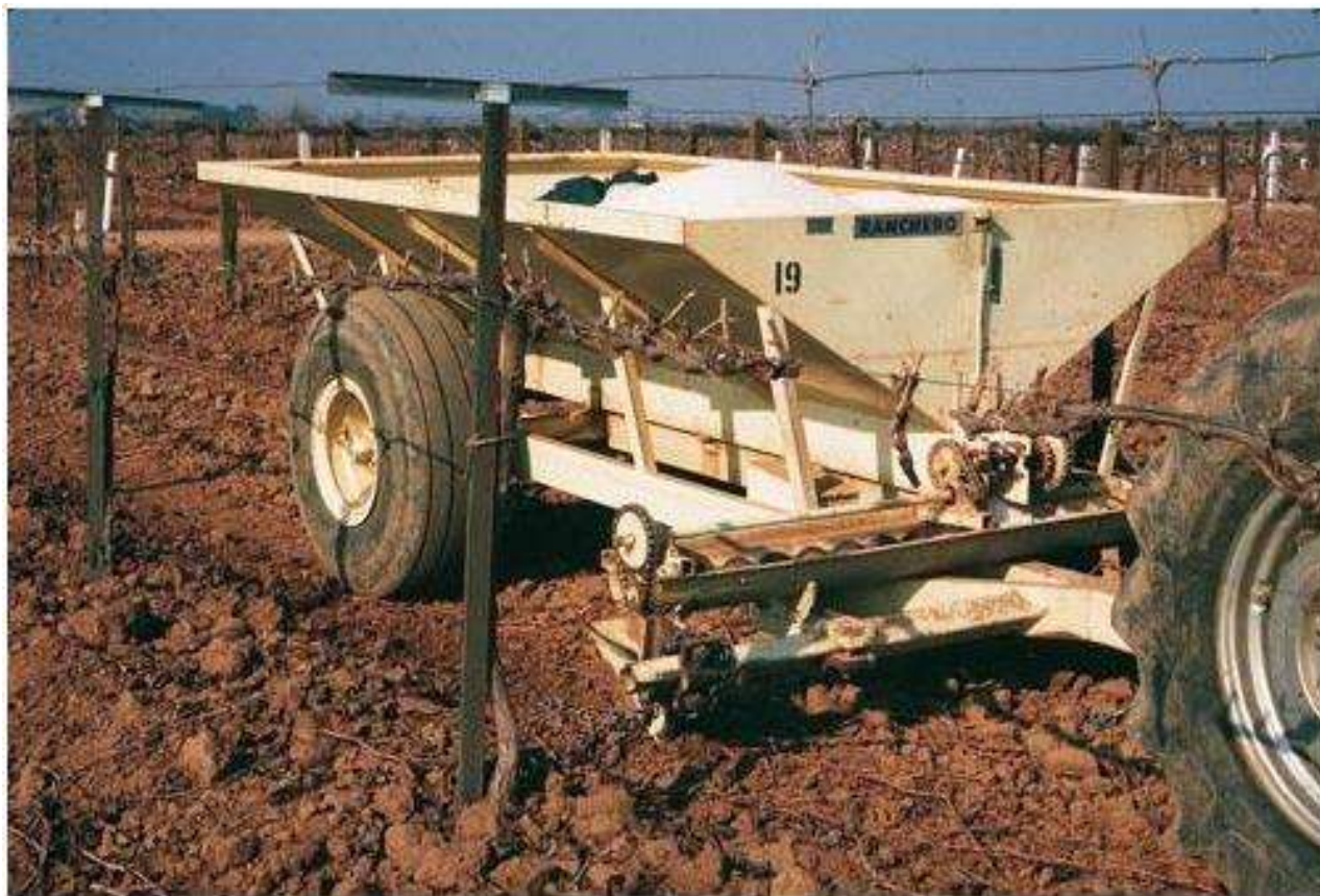
44-rasm. Tokzorlarni organo-mineral o‘g‘itlar aralashmasi bilan kuzgi o‘g‘itlashda qo‘llaniladigan mexanizatsiya
