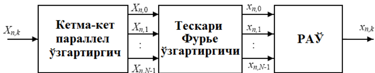
2.16-rasm. OFDM signalini hosil qilish prinsipi.
