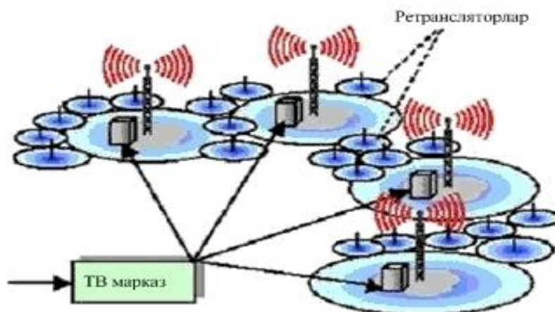
3.12-rasm. DVB-N bir chastotali tarmoq varianti
