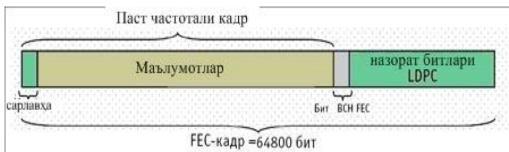
4.1-rasm. Past chastotali kadrning strukturasi (VV kadr)
