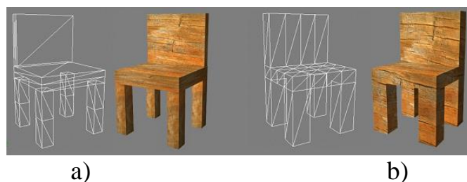
3.20-rasm. “Stul” ob’ektining xomaki nusxasini modellashtirish: a) Model oltita primitivdan tashkil topgan; b) Model poligonlarni tahrirlash orqali yaratilgan.
