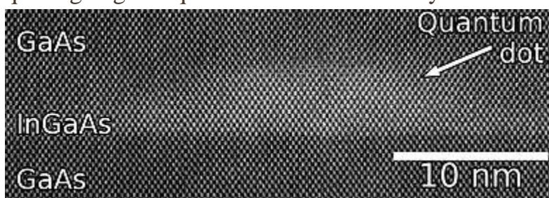
Atom rezolyutsiyasi skanerlash uzatish elektron mikroskopi GaAsga ko'milgan InGaAs kvant nuqtasining tasviri.
