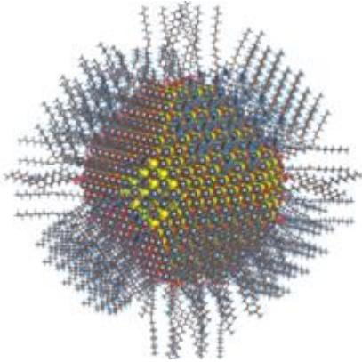
Oleyk kislota, oleyl amin va gidroksil ligandlar bilan to'liq passivatsiyalangan qo'rg'oshin sulfidining (selenid) kolloid nanopartikulining ideal tasviri (hajmi -5nm)
