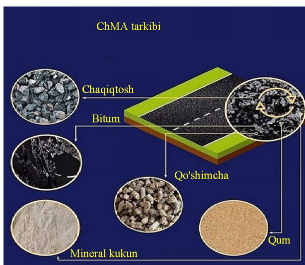
2.3-rasm. Chaqiqtoş mastikli asfaltbeton tarkibi
