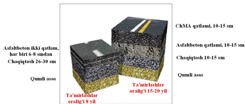
2.15-rasm. ChMA ni qo'llash orqali ta'mirlashlararo muddatni uzaytirish
