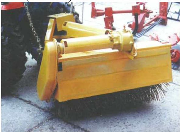
5.1-rasm. Mini traktor KMZ-012 yordamida qoplamani tozalash
