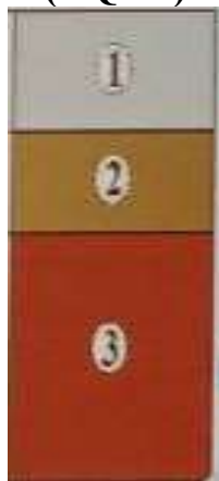
2.11-rasm. 1-sement bilan ishlov berilgan grunt; 2-sanoat chiqindi materiallari bilan grunt qorishmasi; 3-yo'l poyi.
