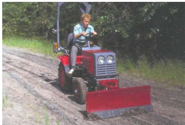
5.1-rasm. Mini traktor KMZ-012 yordamida qoplamani tozalash
