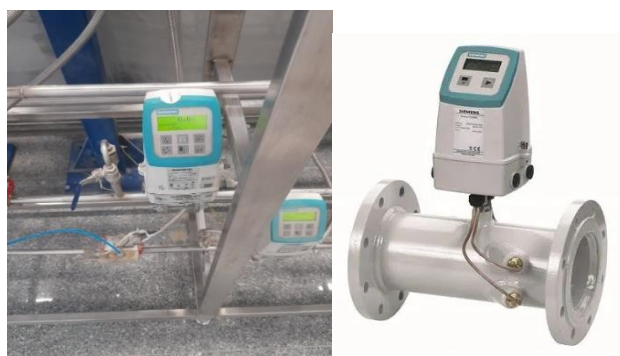
2-rasm. SIEMENS SITRANS F M MAG 5000/6000 elektromagnitniy raqamli sarf o'lchagichi etalon qurilmasiga urnatilishi.
