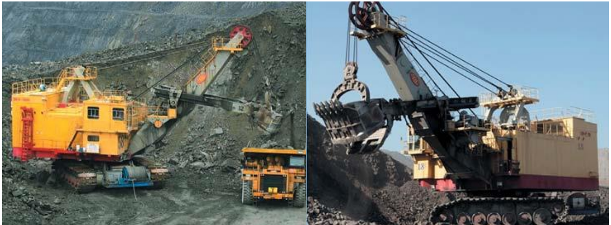
Рasm-9. Tishli reykali kuch berish tizimida ishlovchi to'g'ri lopatali ekskavatorlar: a -EKG-12 Chernigovsk razrezida; b - EKG-18 Krasnobrodsrk razrezida
