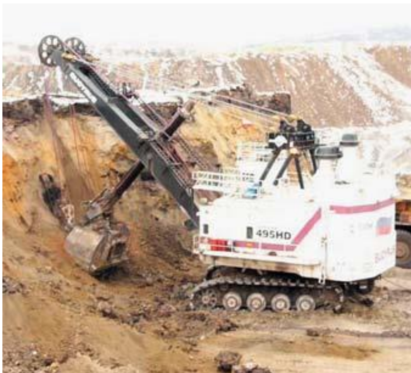
4-rasm. «Tugnuyskiy» ko'mir konida ishlayotgan Cat (Bucyrus) kompaniyasining 495HD ekskavatori
