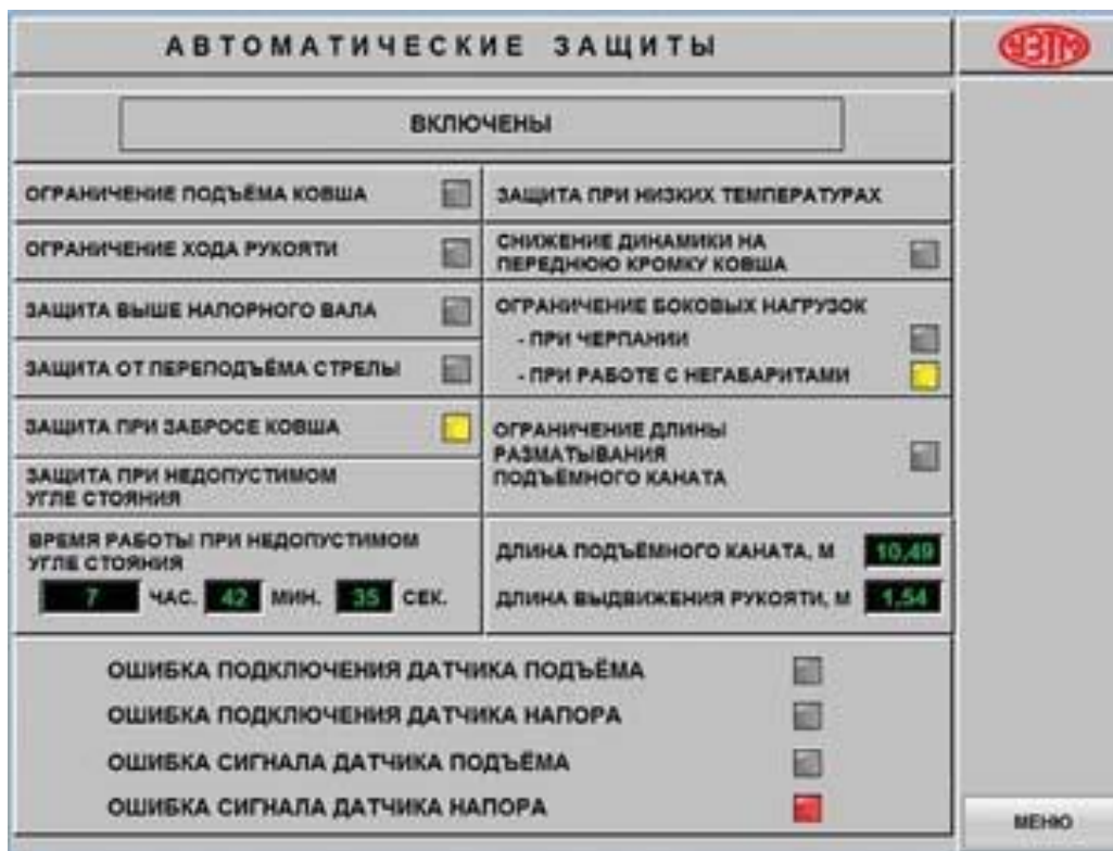
Rasm-10. EKG-12A ekskavatorining ma'lumotlar tizimi ekrani: a – asosiy ekran; b – ishchi uskunalarini avtomatik himoyalash ekrani
