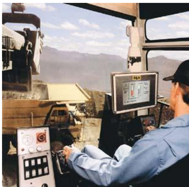
6-rasm. P&H ekskavatorining grafik interfeysli ekrani bilan jihozlangan machinist kabinasi
