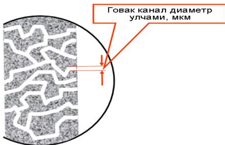
3.4-rasm. G'ovak kanal diametri.
