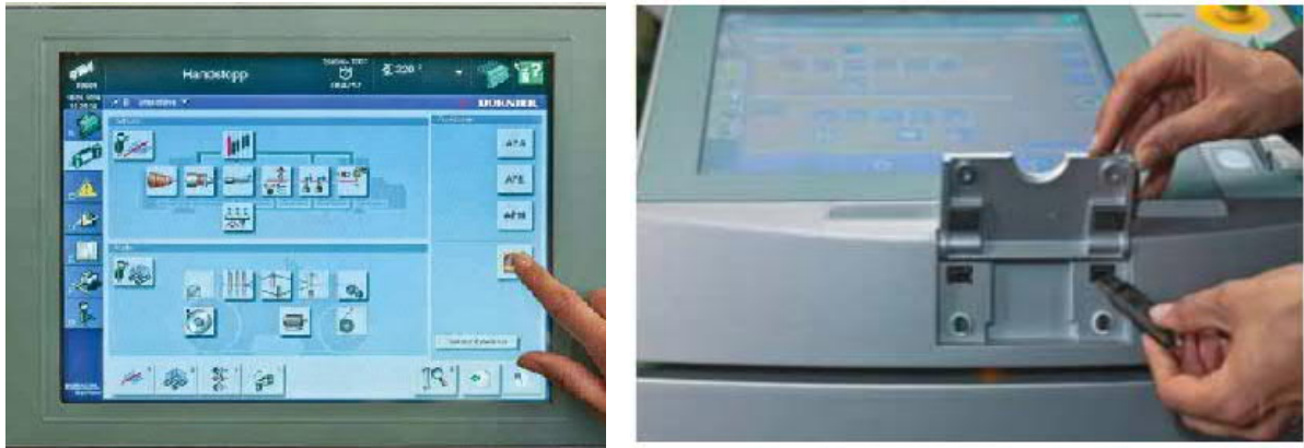
2-rasm. Somet a) va Dornier b) to'quv dastgoxlarini elektron nazorat paneli
