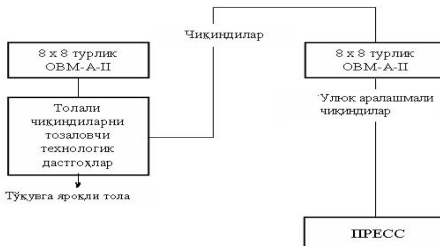
15-rasm. Tolali chiqindilarni tozalashning texnologik sxemasi
