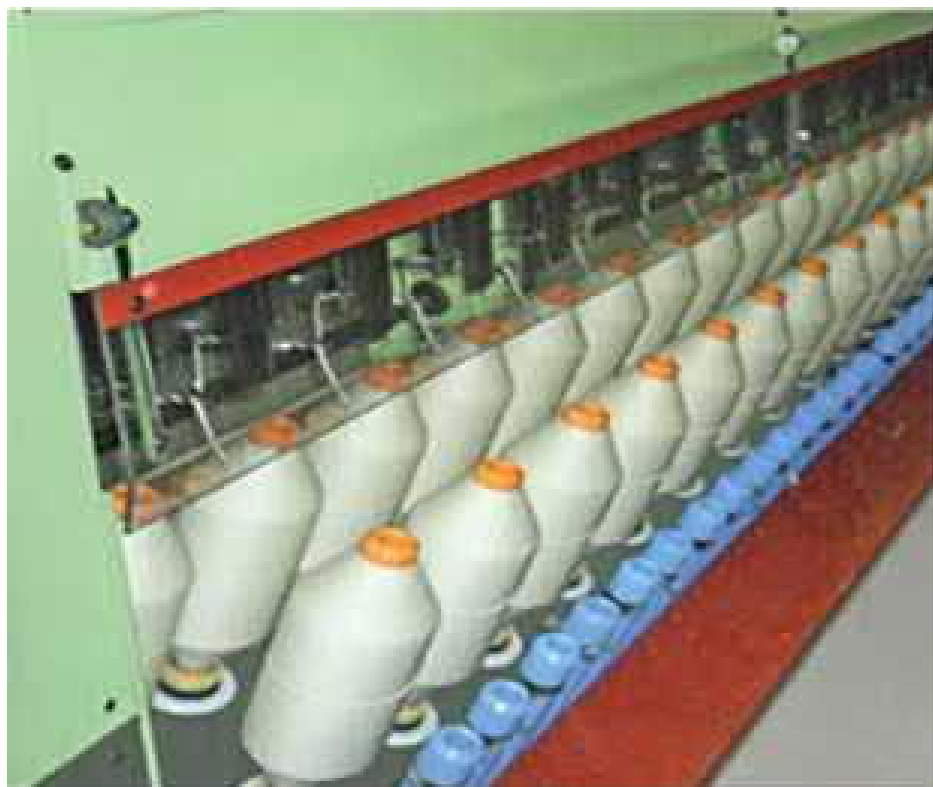
2.8-rasm. G'altak novini og'dirib qo'lda syomga tayyorlash
