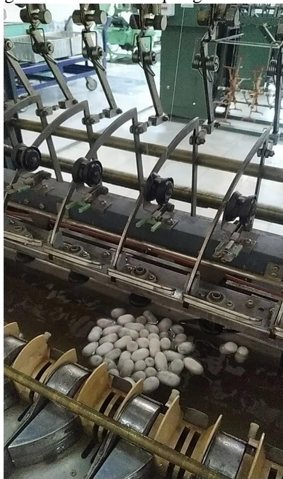
2.3-rasm. Harada avtomat pilla chuvish dastgohida yuqori chiziqli zichlikdagi xom ipak chuvish jarayoni
