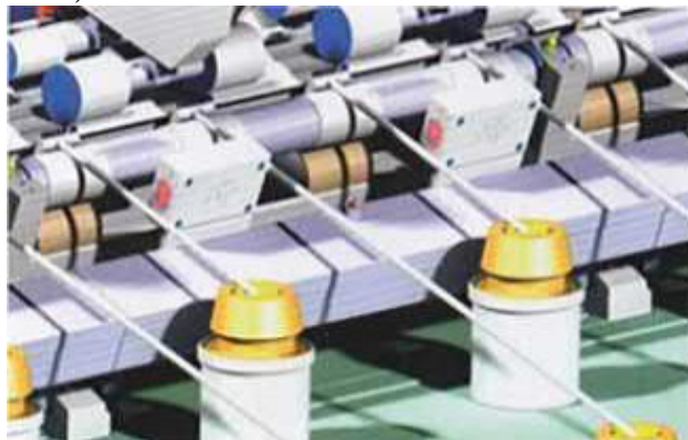
2.5-rasm. Pilik nazoratchisi tizimi o'rnatilishi
