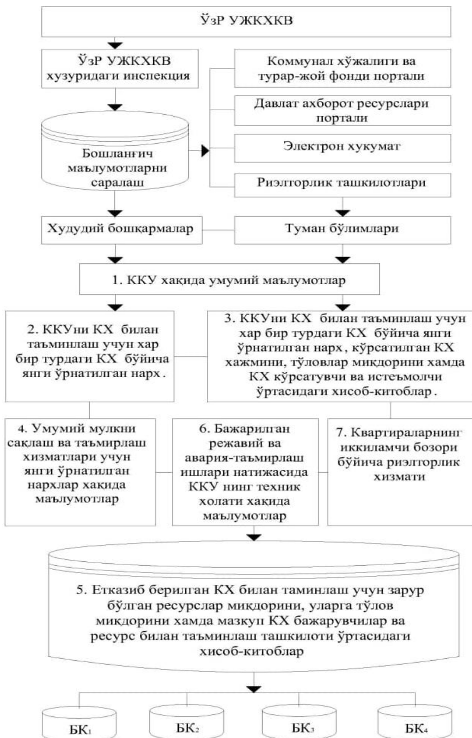
1.15-rasm. KKV ekspluatatsiyasi sifatini oshirish bo‘yicha elektron pasport shaklida monitoring tizimining tarkibiy tuzilishi [130].
