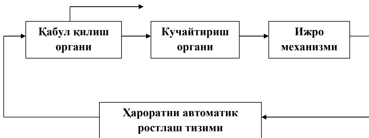
9-расм. Иссикхона шароитида маҳсулот етиштиришда ҳаво ҳароратини автоматик ростлаш тизимининг функционал схемаси.
