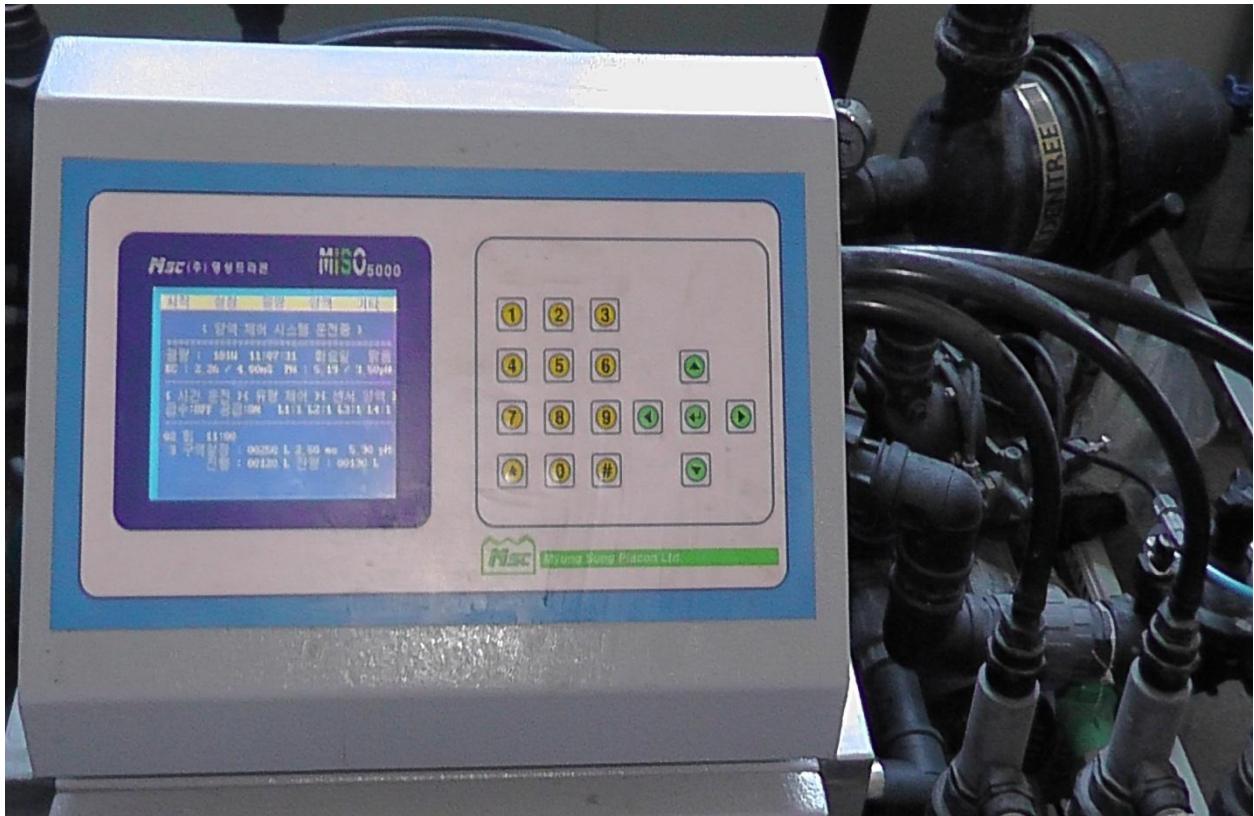
22-расм.Иссикхонада ўсимликларни автоматик озуклантириш микдорини назорат қилиш
