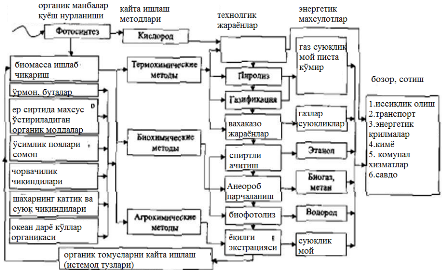
4.1 расм. Биомассадан энергетик маҳсулотлар( биоёқилғи ) олиш усуллари ва технологиялари схемаси
