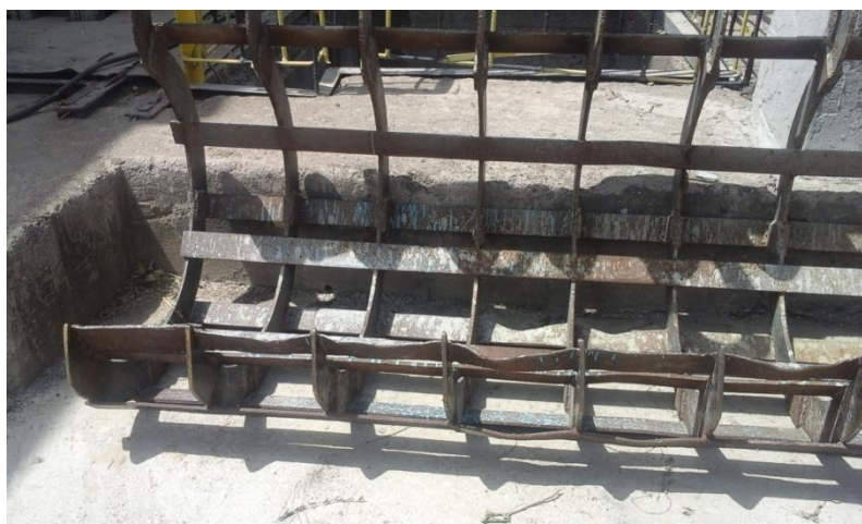
3.20 - расм. Кўқим тозалаш механизми ва унинг ишчи органи
