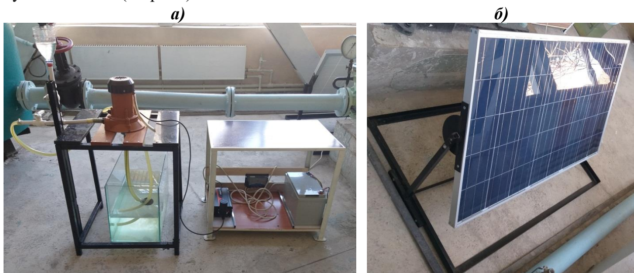
69-расм. Кафедра лабораториясига ўрнатилган 170 Вт ли «Агидель» қуёш насос энергоқурилмаси
