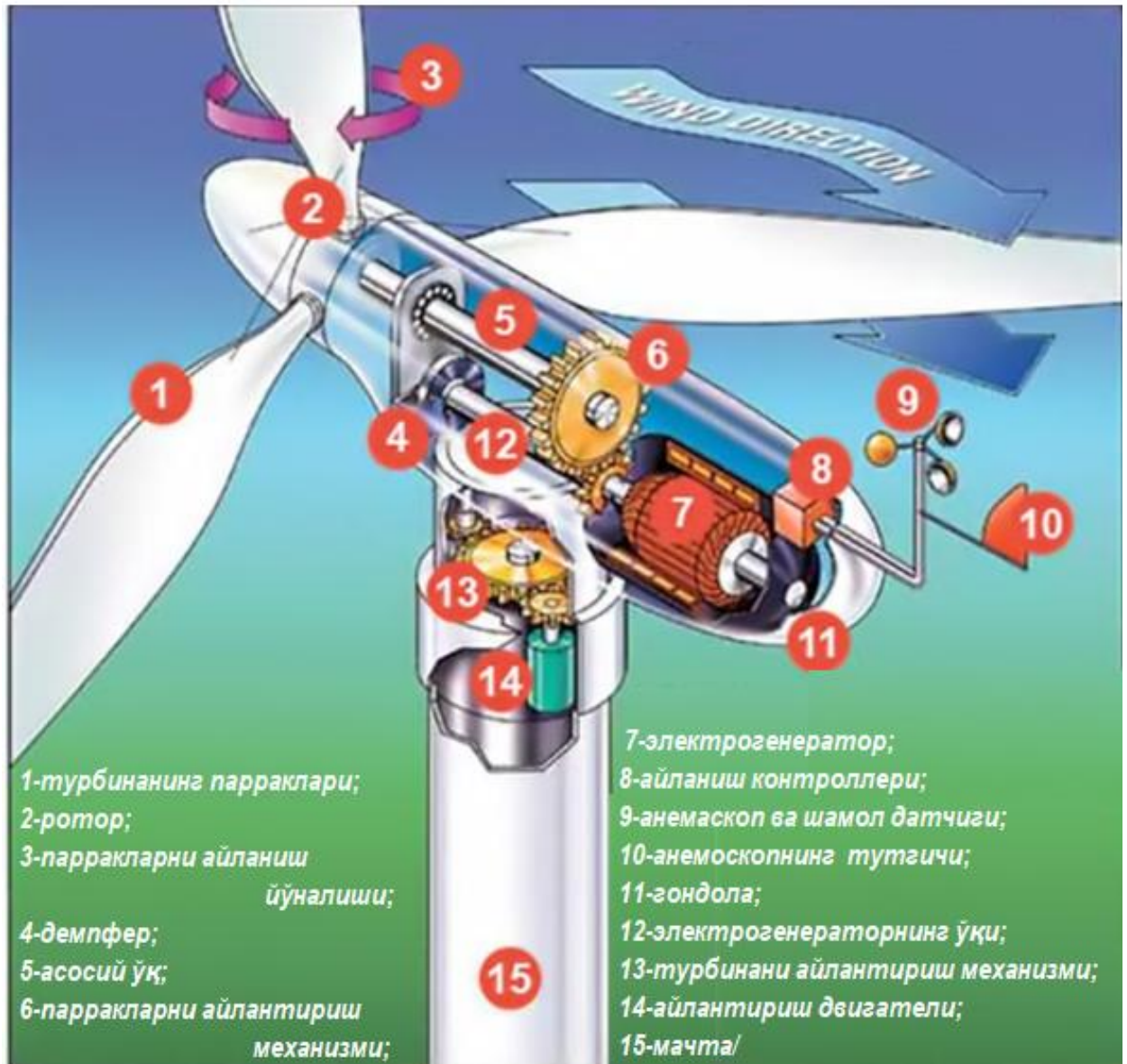
52-расм. Шамол энергоқурилмаларининг тузилиши.
