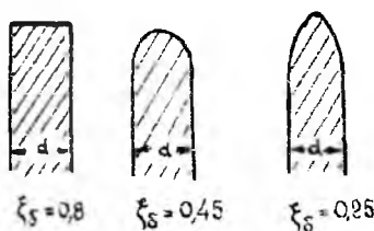
Рис. 12.5. Форма быков в плане и коэффициенты уменьшения
