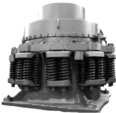
20-rasm. KSD-1750T modeli o'rta maydalaydigan konusli maydalagich.
