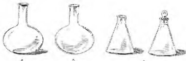
4-rasm. Kolbalar: a-tagi yassi; b-tagi dumaloq; v-konussimon
