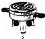
41-rasm. Elektr plitkalar: a-yopiq tipdagi; b-ochiq spiralli
