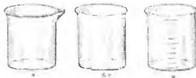
3-rasm. Kimyoviy stakanlar: a-burunchali; b-burunchasiz; v-kalibrovka qilingan
