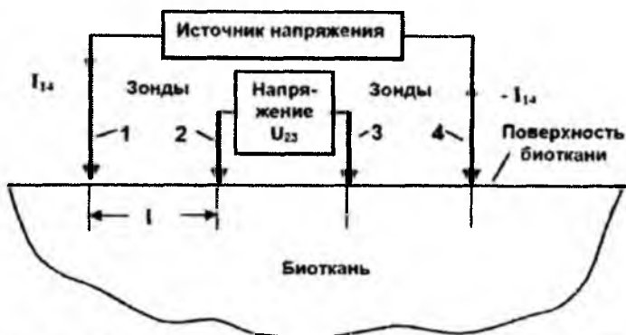
Рис. 3.2. Схема измерений четырехзондовым методом.
