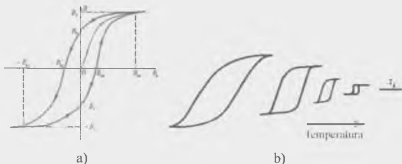
11.6-rasm. Magnit material B(H) oʻzgarish grafigi a) va gisterezis sirtmogʻining haroratga boʻliqligi b 26 .
