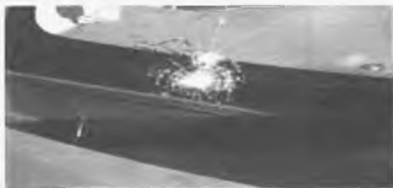
9.3-rasm. Tripleks shishasidan yasalgan avtomobil oynasiga tosh urulishida hosil boʻlgan shikastlanish-buzilish-sinish.
