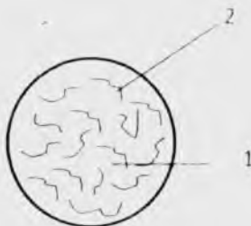
12.6-rasm. Qisqa tolalar bilan to'ldirilgan plastmassalar: 1—bog'lovchi asos; 2— to'ldiruvchi qisqa tola.
