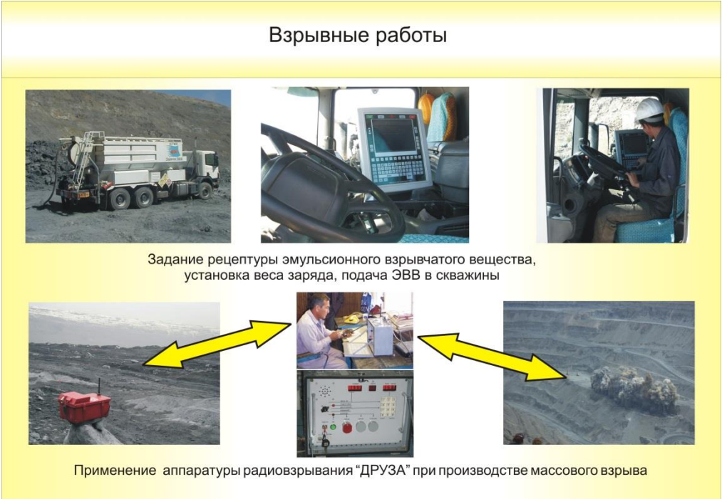
Chizma 2. Sanoatlashtirilgan Emulsion portlovchi moddalari bilan portlatish usullari
