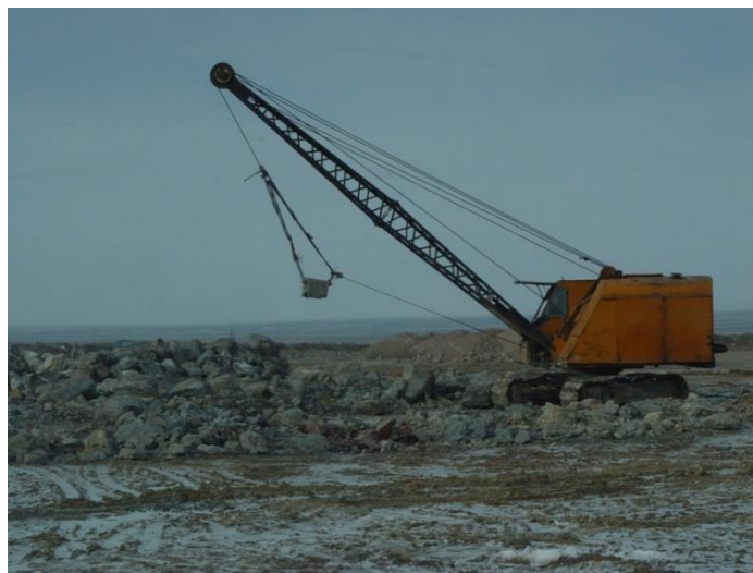
1 Rasm. Draglaynning umumiy ko‘rinishi.
