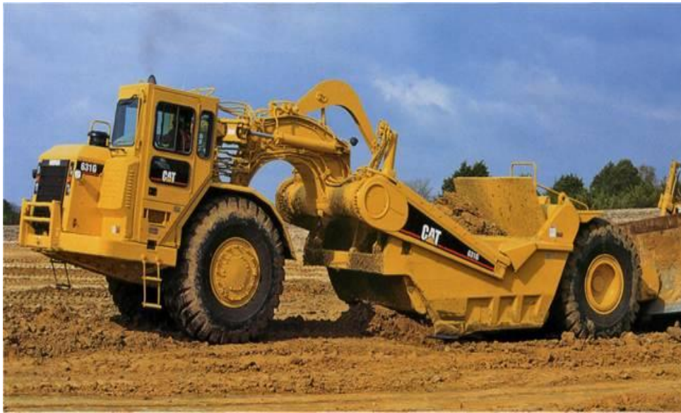
6 rasm. Skreperning umumiy ko‘rinishi.
