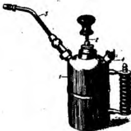
2.52-rasm. Pnevmatik dastakli purkagich «Dezinfab» ning umumiy ko‘rinishi: 1- rezervuar, 2- porshen, 3- changlatgich, 4- suyuqlik quyiladigan teshikni bekitib turadigan qalpoqcha
