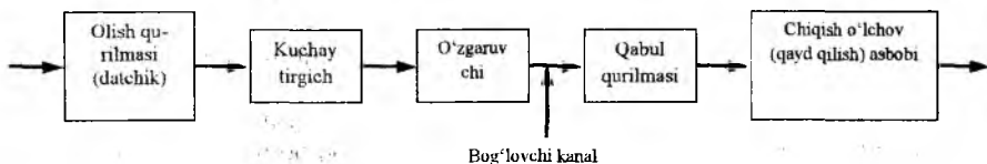
2.55 – rasm. Dozimetrlar ishlash prinsipining umumiy sxemasi
