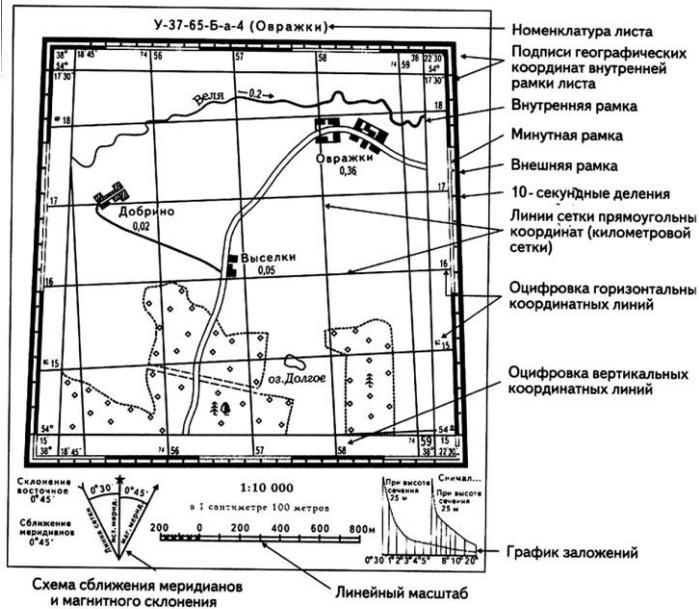
Рис. 8. Координатная сетка на топографических картах
