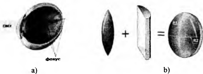
7.18-rasm. Astegmatik ko'zda tasvirning fokuslanishi (a) va uni tuzatish uchun qo'llaniladigan sferik linzalar sistemasi (b)
