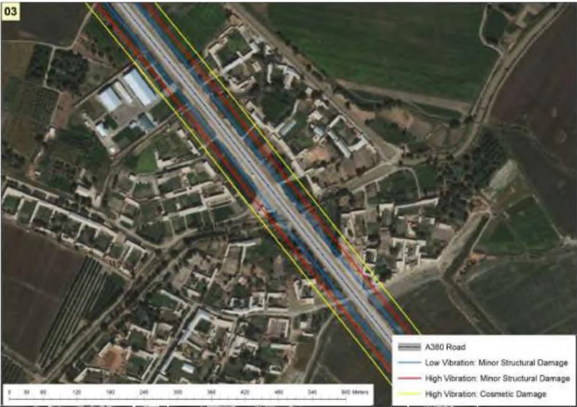
Rasm A4 Vibratsiyali shikastlanish konturlari yuqori xavfli (Adobe) binolar uchun: Chandir va Suspata
