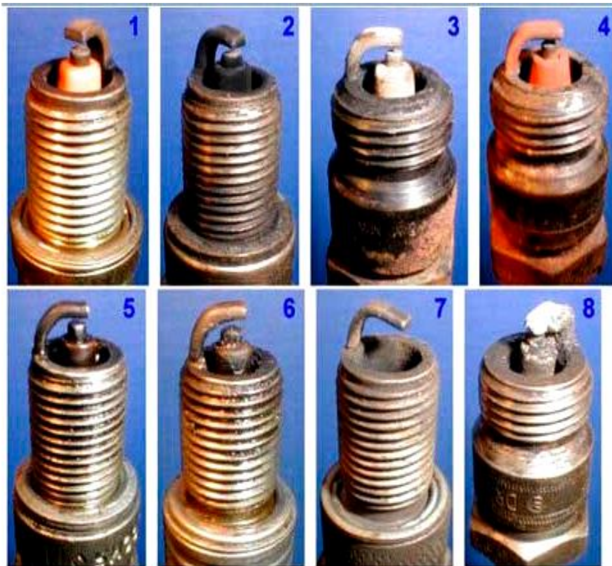
2.45-rasm. Chaqmoqlarning ishlash jarayonidagi nosozlik ko‘rinishlari: 1-me‘yoriy chaqmoq, 2-dvigatel boy aralashmada ishlaganda, 3-dvigatel kambag‘al aralashmada ishlaganda, 4-yonilg‘i tarkibida qo‘shimchalar miqdori oshib ketganda, 5-klapan yo‘naltiruvchisi salnigining qotib qolishi, 6-klapanning kuyishi yoki porshen halqalari ariqchalarining sinishi, 7-past oktan sonli benzindan foydalanish natijasi, 8-porshenning moy sidirgich halqasini qisilib qotishi natijasida moyning yonishi.
