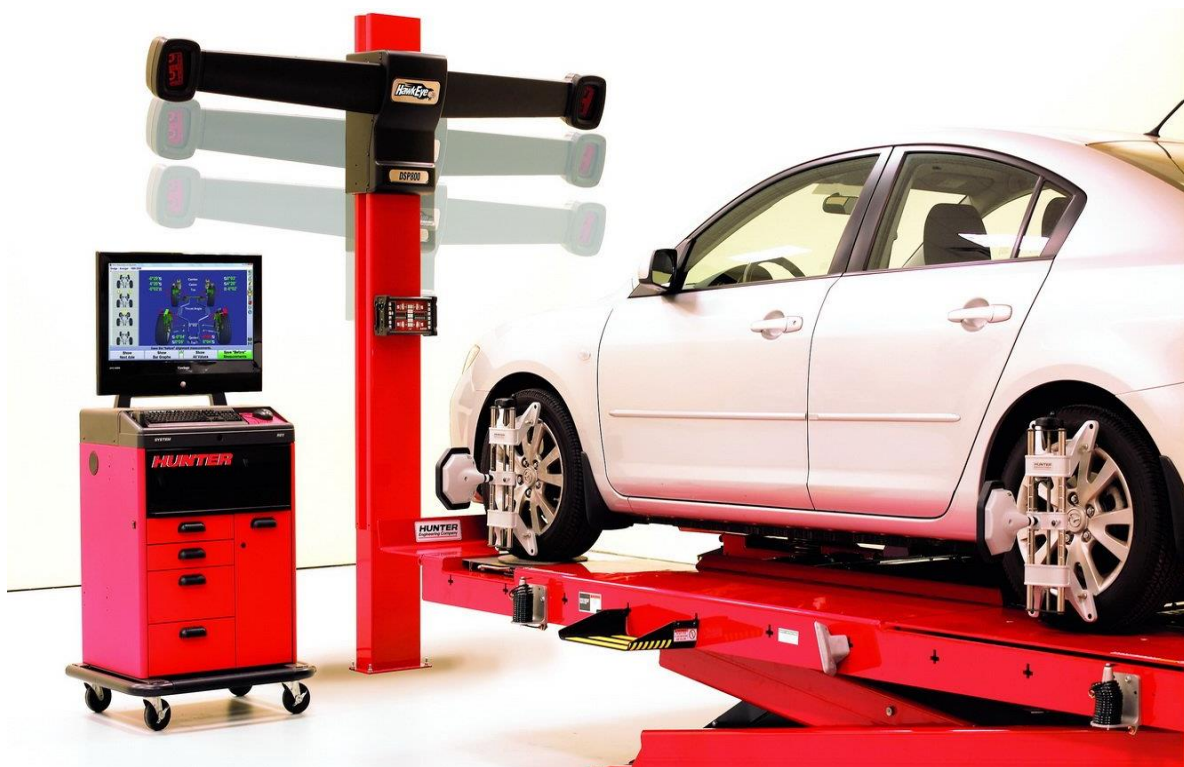
2.71-rasm. Avtomobil g'ildiraklarini o'rnatilgan burchaklarini tekshirish jihozi
