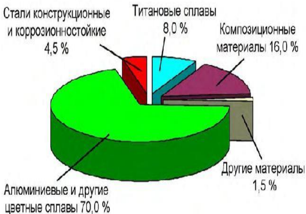
Рис 2. Конструкционные материалы, применяемые в авиастроении
