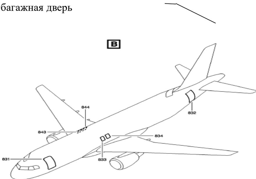
Дверь отсека задняя багажная заднего багажника
