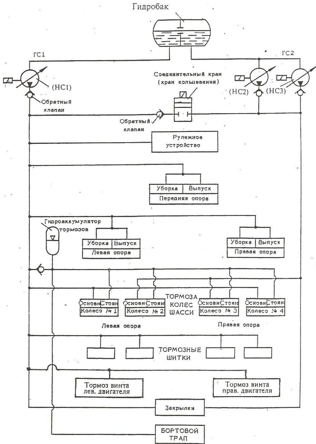
Рисунок № 2 Блок схема гидросистем.
