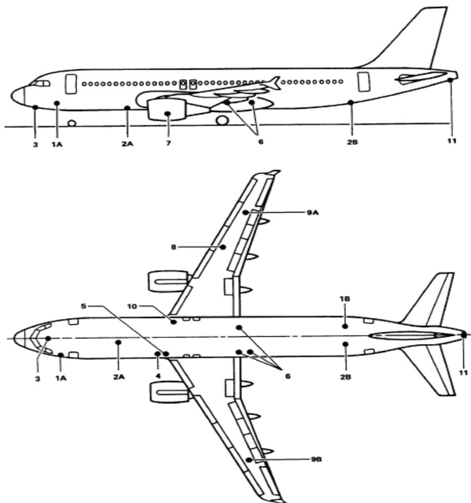
Рис. 3 Люки и отсеки для обеспечения наземного обслуживания
