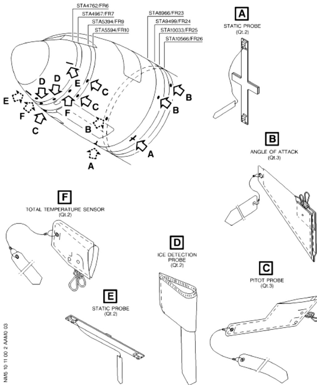
Рис. 17 Заглушки датчиков АиРЭО
