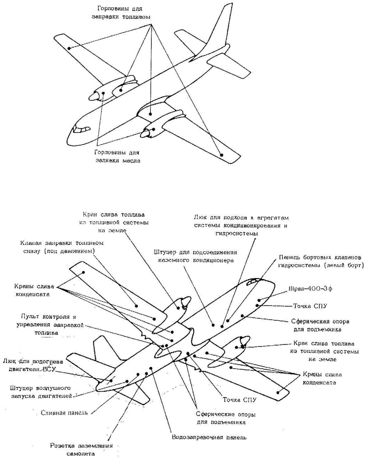
рис.1. Схема расположения основных точек обслуживания самолёта
