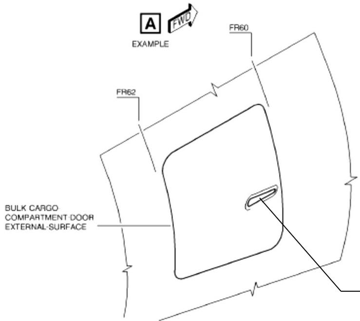
ручка открытия – закрытия двери изадного отсека багажника.
