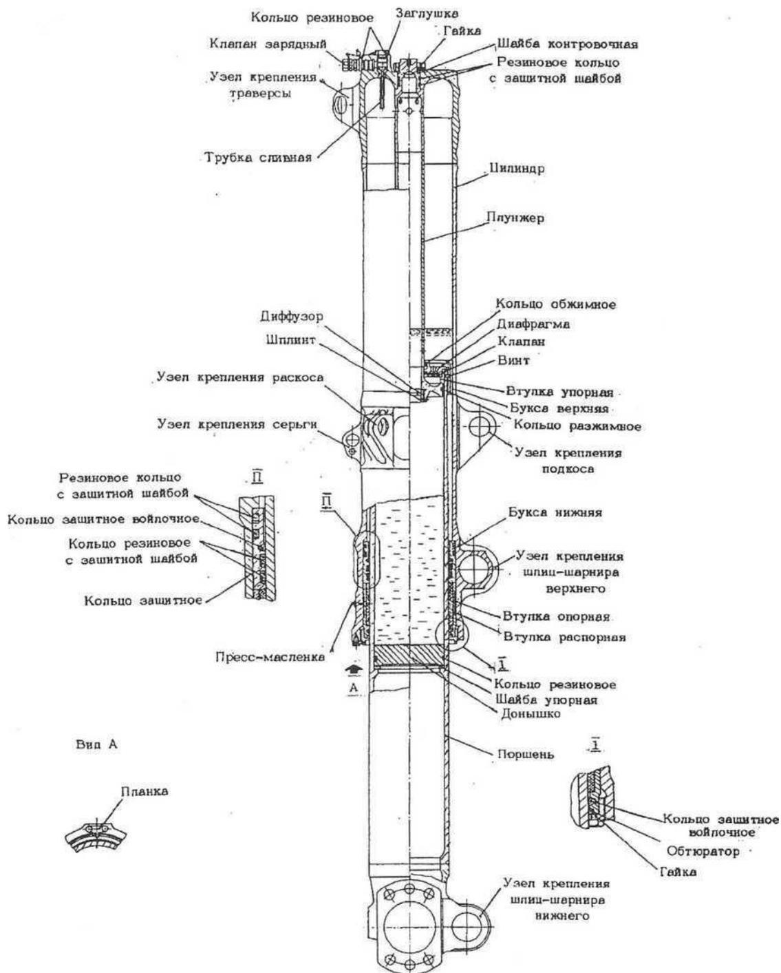
Рисунок 2. Амортизатор основной опоры
