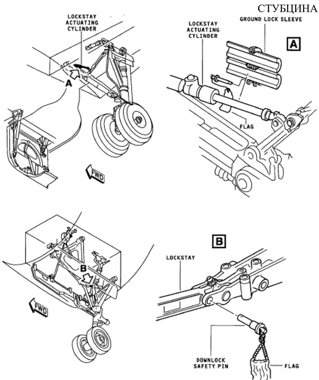
Штырь-фиксатор передней стойки шасси
