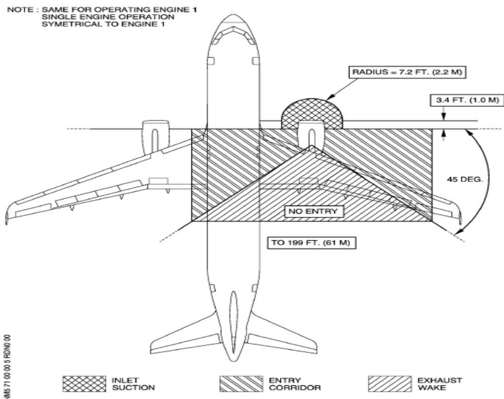
Рис. 25 Схема опасных зон при работающем двигателе
