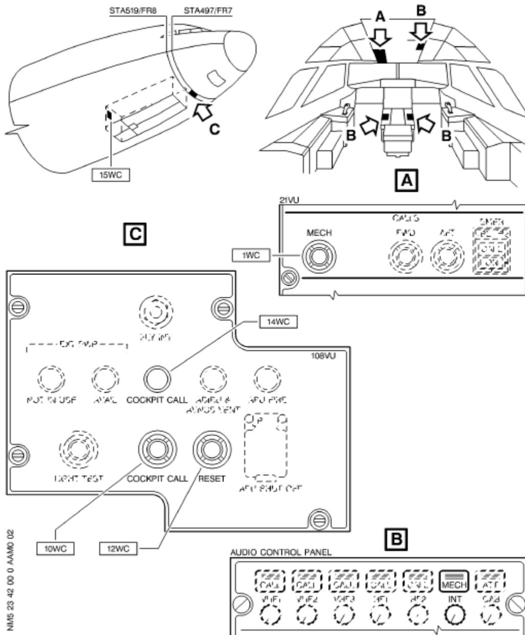
Рис. 5 Панель подключения СПУ
