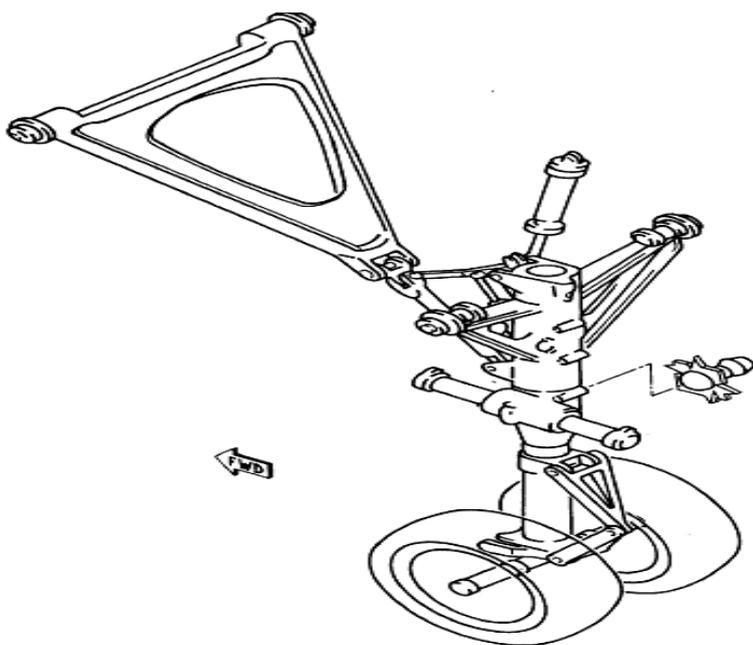
Рис. 22 Точка заземления на передней стойке шасси
