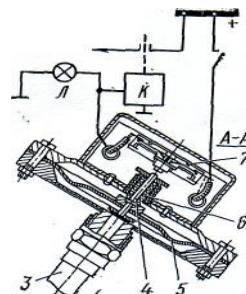
замкнутые контакты. Сигнальная лампочка или табло при этом гаснет, указывая на отсутствие обледенения передней кромки агрегата.
