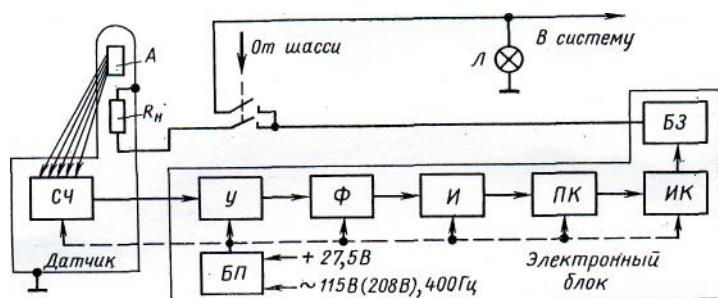
Рис. 4. Структурная схема радиоизотопного сигнализатора типа РИО-3
