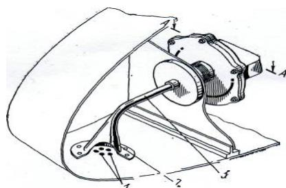
Рис. 3. Компоновка и принципиальная схема пневмоэлектрического сигнализатора обледенения:
