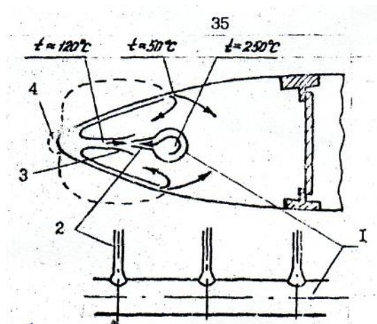
Рис. 1. Схема носовой части крыла (оперения), оборудованной воздушно-тепловой ПОС:
