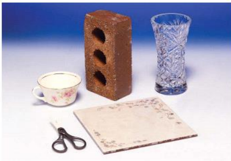
3.4-rasm. Keramik materiallardan tayyorlangan oddiy maxsulotlar – qaychi ushlagichi, choy uchun chashka, qurilish g'ishti, taglik va shisha vaza.
