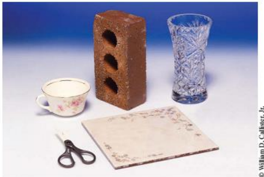
Rasm 2.4. Keramik materiallardan tayyorlangan oddiy maxsulotlar – qaychi ushlagichi, choy uchun chashka, qurilish g'ishti, taglik va shisha vaza.
