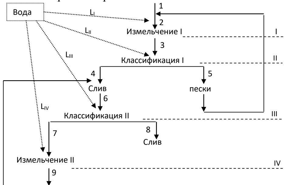
1 Rasm. Ikki bosqichli silliqlash sxemasi
