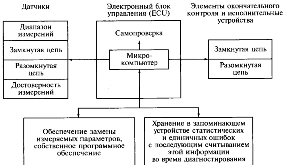
4. rasm. Bortga oʻrnatilgan diagnostikalash funksiyalari
