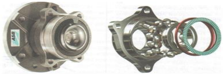
4.17-rasm. NTN-SNR kompaniyasi ishlab chiqargan ASB tizimli podshipnik (yig‘ilgan va yig‘ilmagan ko‘rinishi)
